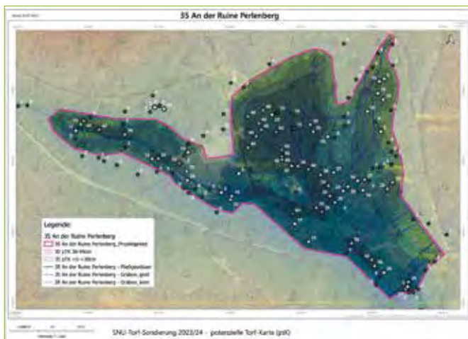
Abb. 5: Ergebnisse der Torfsondierung zwischen Kolbental und Ruine Perlenberg.
